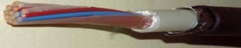
Biztosítóberendezési földkabel érszám: 14 műanyag szigetelés, réz kábelér érátmérő 1 vagy 1,5 mm 2
